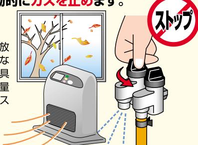
未使用的ガス栓を誤開放したり、季節の変わり目などで、急に多くのガス器具を使用するなど異常に大量のガスが流れたとき、ガスを自動的に止めます。
